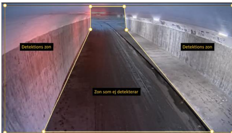
Figur 6. Översikt bilden i tunneln illustrerar zonerna i sensorn
